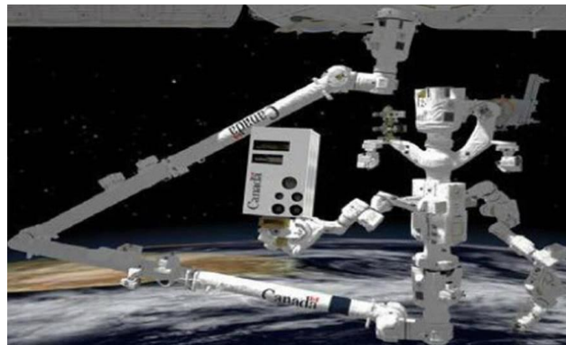
Şekil 2.6. Dextre'nin (CSA) ucundaki DDVS sensörü.
